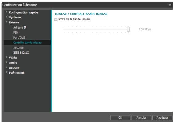
Sélectionnez **Limite de la bande réseau**, puis définissez la bande réseau maximum. La caméra ne sera pas en mesure d'utiliser plus que la limite indiquée en cas d'événement de trafic réseau.
