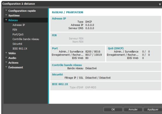
Modifie les paramètres réseau, active FEN et les fonctionnalités de sécurité et contrôle l'utilisation de la bande réseau
