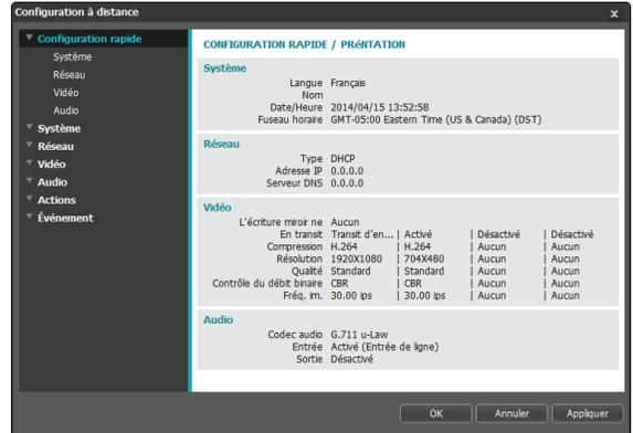
La configuration rapide permet de configurer les paramètres **Système**, **Réseau**, **Vidéo**, **Audio** ainsi que d'autres paramètres de base pour l'utilisation de la caméra.
