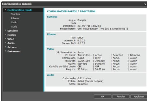
Dans l'écran Configuration à distance, sélectionnez le menu à gauche afin d'afficher les paramètres en vigueur. Sélectionnez une option dans le menu afin de modifier les paramètres correspondants. Pour appliquer les paramètres et quitter la fenêtre Configuration à distance une fois que les paramètres ont été modifiés, cliquez sur **OK**.
